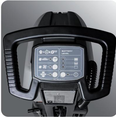
Interrupteur à clé on/off contre toute utilisation non autorisée. Protection contre les surcharges, altération décharge de batterie (seulement CC) et fonctionnement inattendu. Entretien par un seul interrupteur pratique sur la brosse. Configuration Eco Energy pour temps d'utilisation prolongés et opérations particulièrement silencieuses (seulement CC).
